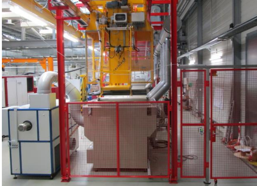
Figura 15. Galvabau (línea automática muy completa de pavonado). https://www.galvabau.swiss/en/portfolio/special-barrel-blackening-line/
