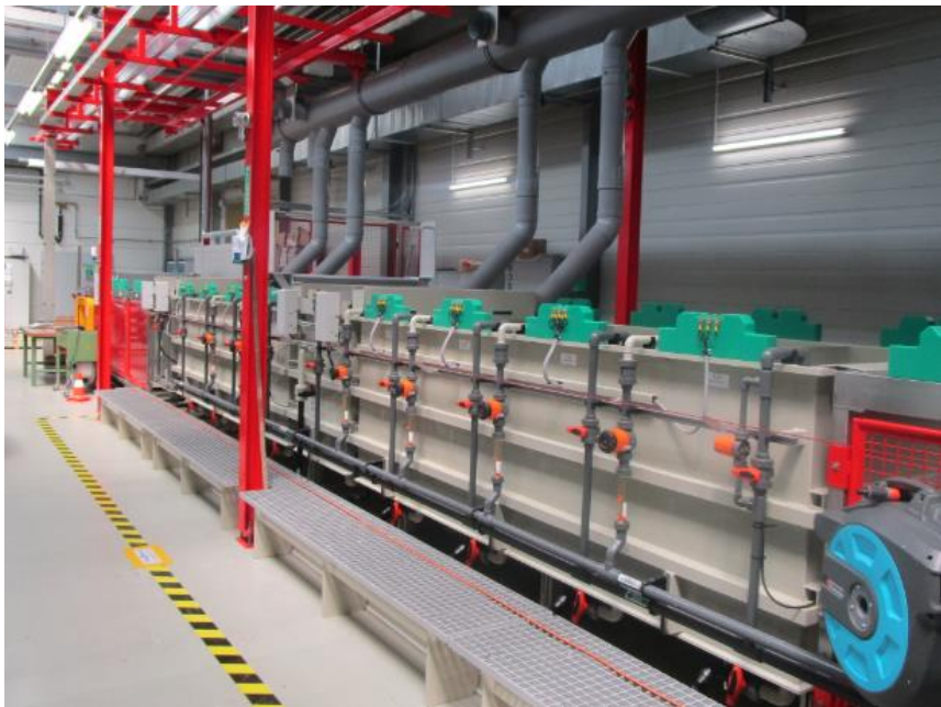
Figura 14. Galvabau (línea automática muy completa de pavonado). https://www.galvabau.swiss/en/portfolio/special-barrel-blackening-line/
