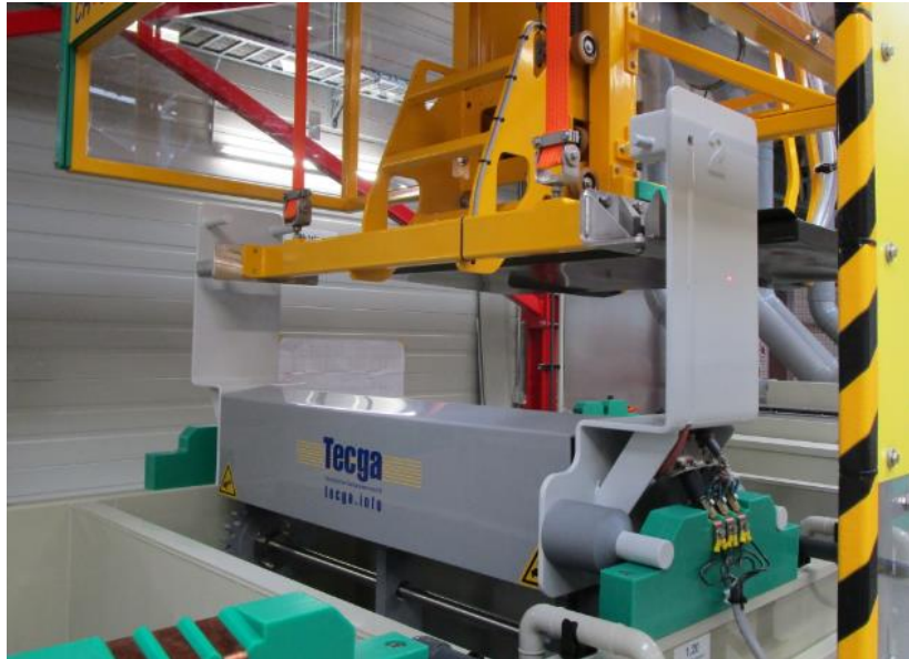
Figura 17. Galvabau (línea automática muy completa de pavonado). https://www.galvabau.swiss/en/portfolio/special-barrel-blackening-line/
