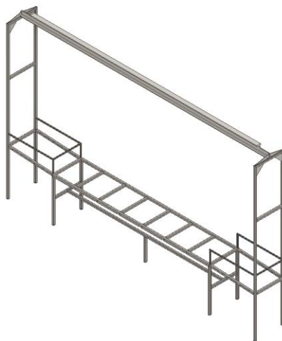
Figura 54. Diseño 4 de la estructura de la línea de pavonado. Elaboración propia “SolidWorks”.
