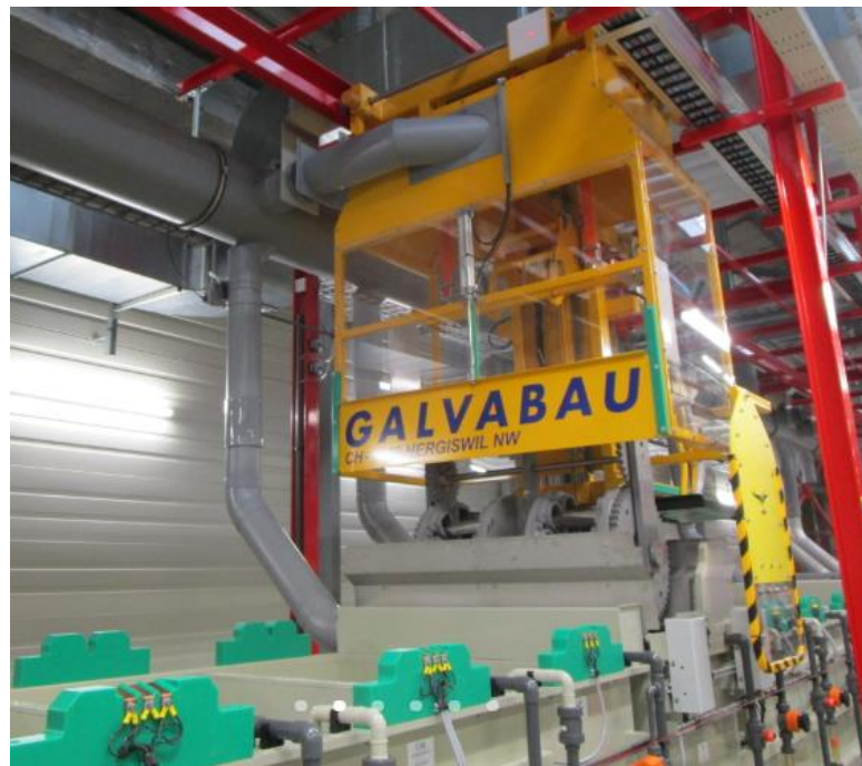
Figura 16. Galvabau (línea automática muy completa de pavonado). https://www.galvabau.swiss/en/portfolio/special-barrel-blackening-line/
