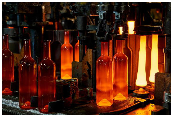
Fig. 2.16 Proceso de fabricación de una botella de vidrio
