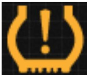
*Ilustración 4. Alerta de presión inadecuada de los neumáticos.*
