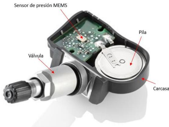
Ilustración 21. Montaje sensor de presión de los neumáticos.
