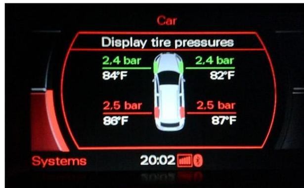
Ilustración 5. Visualización de la presión de cada neumático en un modelo avanzado de TPMS.
