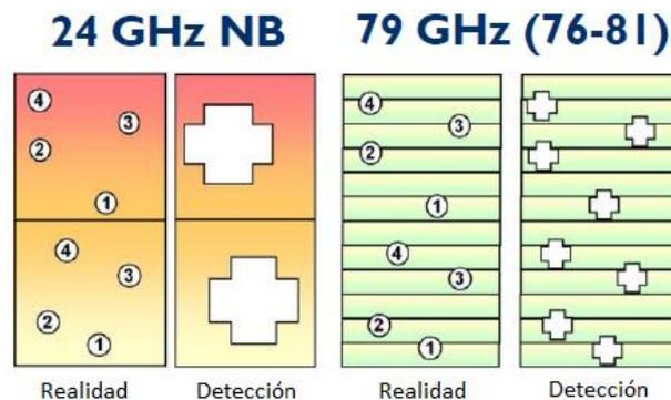
Ilustración 55. Comparación de la distinción de objetos dependiendo de la frecuencia de onda de radio.
