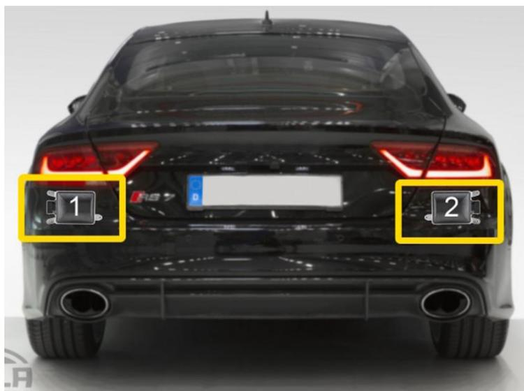
Ilustración 59. Situación de los sensores de corto alcance correspondientes al sistema “Asistente de cambio de carril”.
