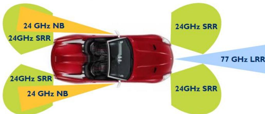
Ilustración 56. Sensores radar y su frecuencia en el sistema que se venía utilizando hasta la generalización de la frecuencia de 76-81 GHz.
