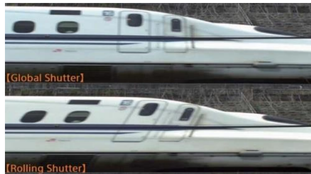
Figura 26. Comparación entre una imagen tomada con shutter común (arriba) y tomada con shutter rotativo (abajo). (Sony, 2017)
