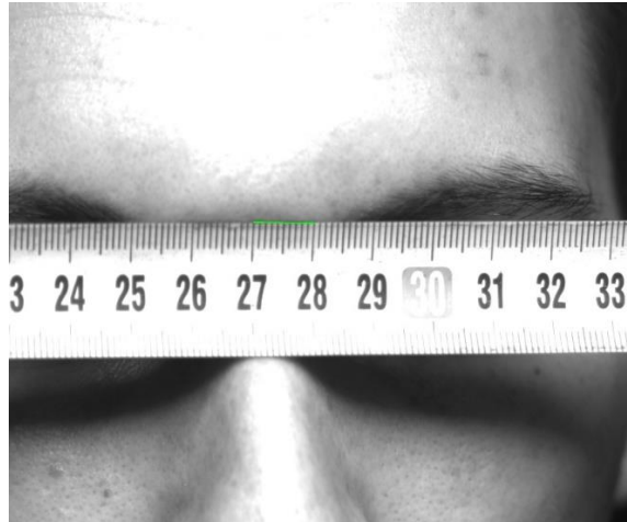
Figura 32. Imagen obtenida de la calibración para determinar la relación entre píxeles y milímetros. Nótese en verde la distancia seleccionada.
