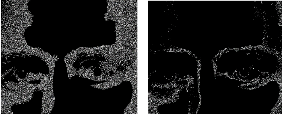
Figura 48. Resultados del algoritmo de Canny para distintos umbrales.
