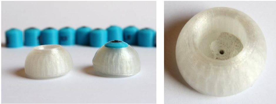
Figura 19. A la izquierda, detalle de los dos ojos con las pupilas al fondo. A la derecha, detalle del taladro realizado en el interior del globo ocular para facilitar la extracción de la pupila introducida.
