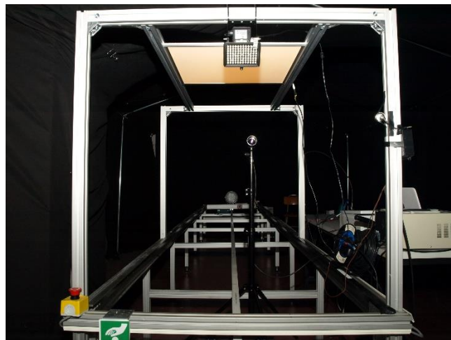
Figura 61. Estructura desde el punto de vista del sujeto objeto de los ensayos. Véanse la cámara y el foco infrarrojo en la parte superior.
