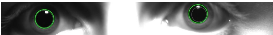
Figura 51. Imagen en la que se puede apreciar, en el ojo derecho, el círculo detectado mediante la Transformada de Hough (gris) y el círculo detectado mediante el algoritmo implementado (verde).
