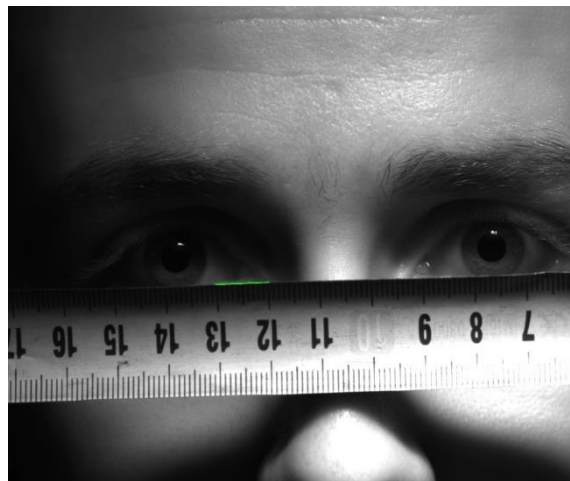
Figura 33. Imagen obtenida de la calibración para determinar la relación entre píxeles y milímetros. Nótese en verde la distancia seleccionada.
