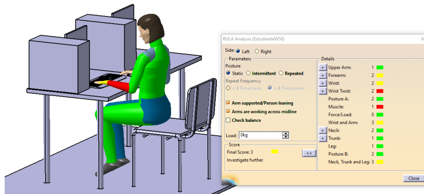
Fig. 60. Resultados del método RULA del lado izquierdo del cuerpo de una mujer de percentil 50 en el aula 21. Fuente: Elaboración propia.
