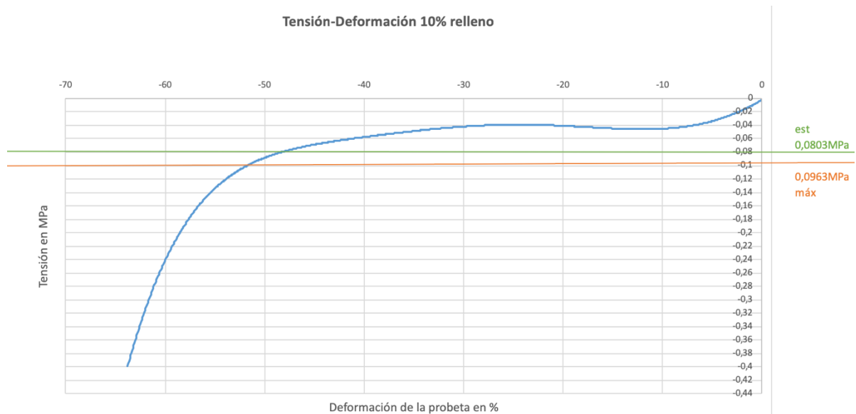
Ilustración 112. Curva tensión-deformación para un relleno de 10%.
