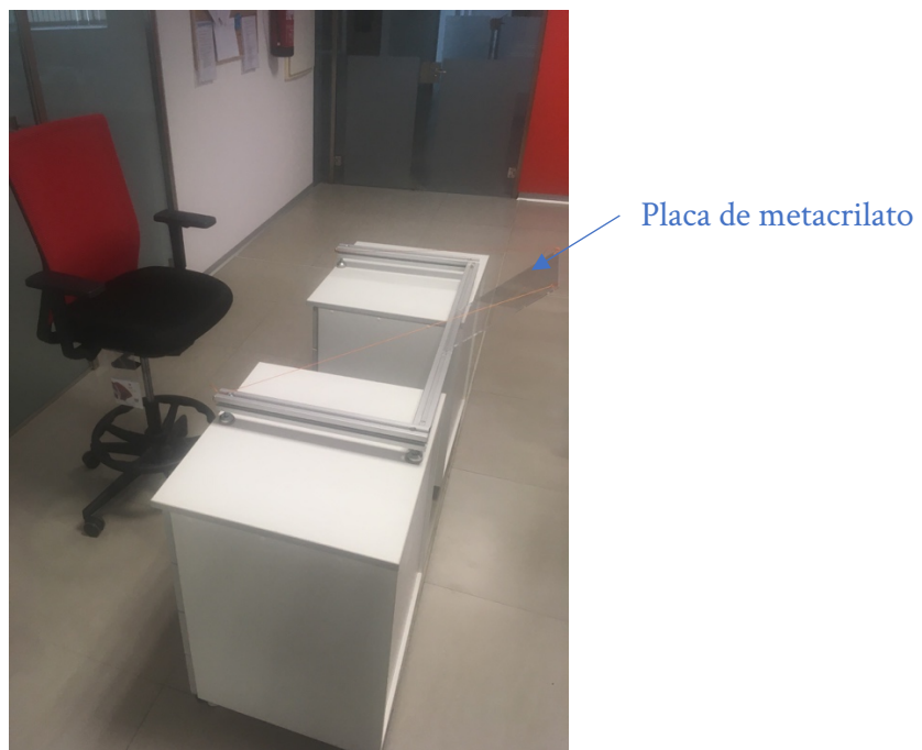
Ilustración 59. Estructura generada para el escaneo 3D del pie.
