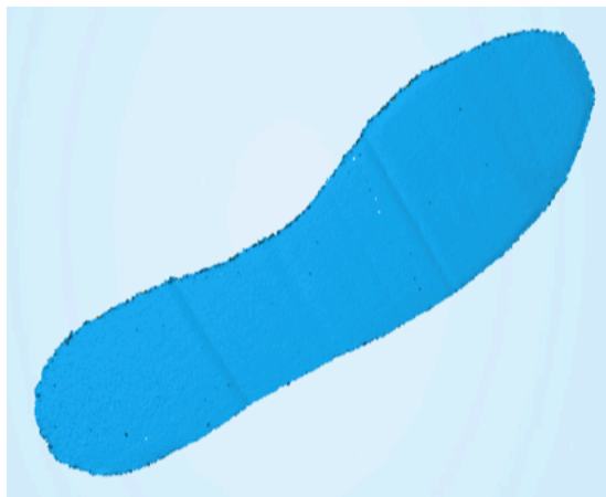
Ilustración 92. Reproducción de la suela interna del zapato escaneada.
