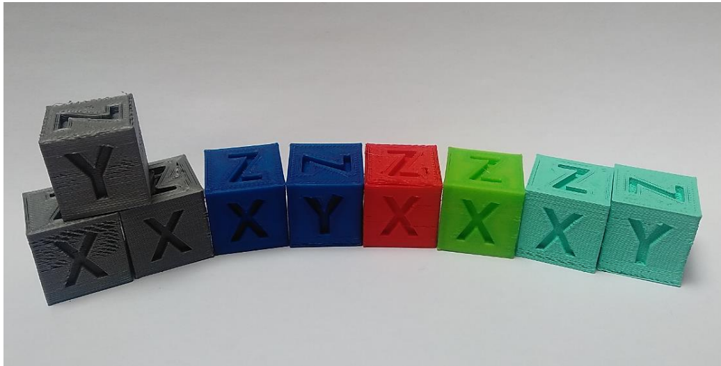
Figura 21. Cubos de calibración
