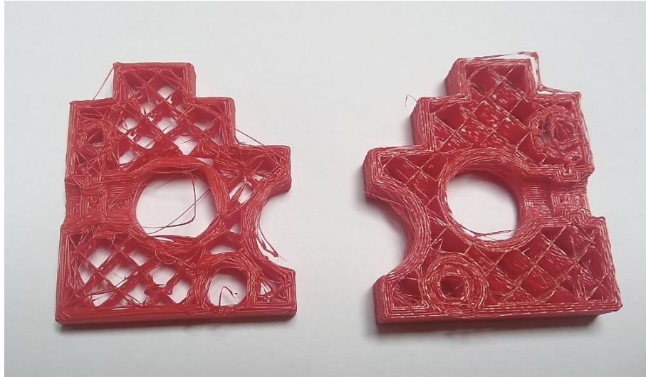
Figura 27. Baja temperatura y exceso de velocidad
