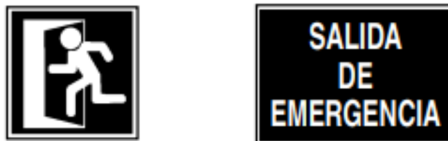
Figura 2 Salidas de emergencia. Fuente: UNE 23034 6
