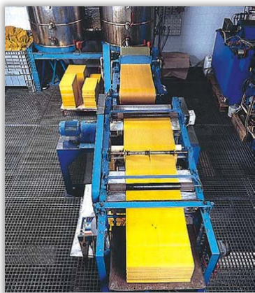
Figura 3. Laminadora y troquel industrial para estampado.
