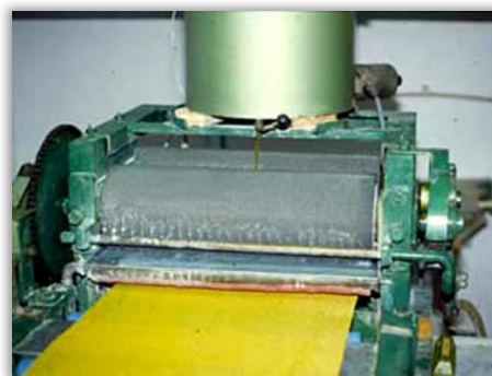
Figura 3. Laminadora y troquel industrial para estampado.
