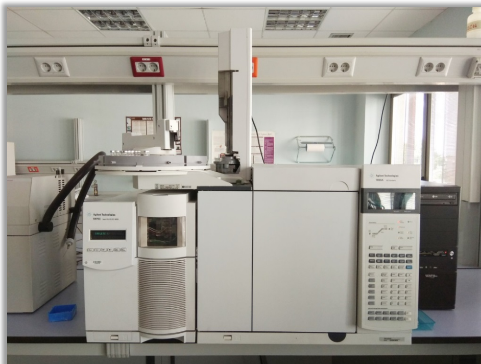
Figura 7. Cromatógrafo de gases Agilent Technologies series 7890 A acoplado a detector de espectrometría de masas Agilent Technologies 5975 C .
