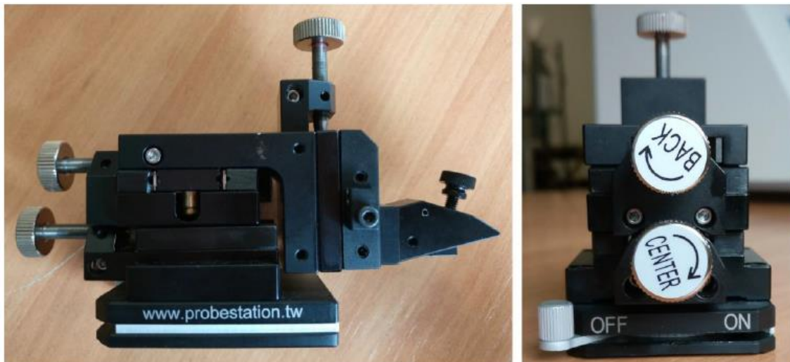
Figura 3.10: Microposicionador de laboratorio
