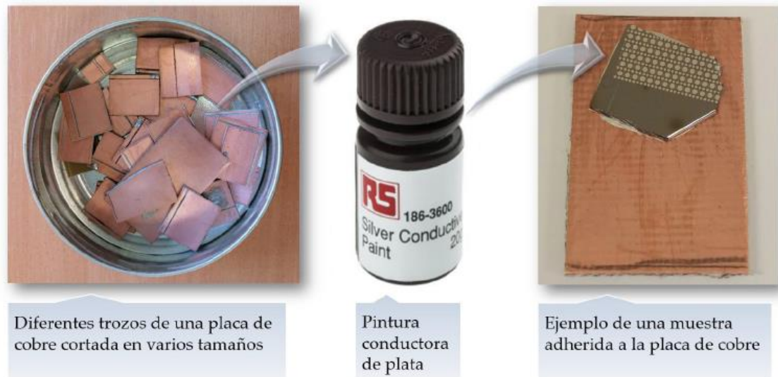
Figura 4.3: Placas de cobre, adhesivo de pintura conductora de placa y muestra preparada
