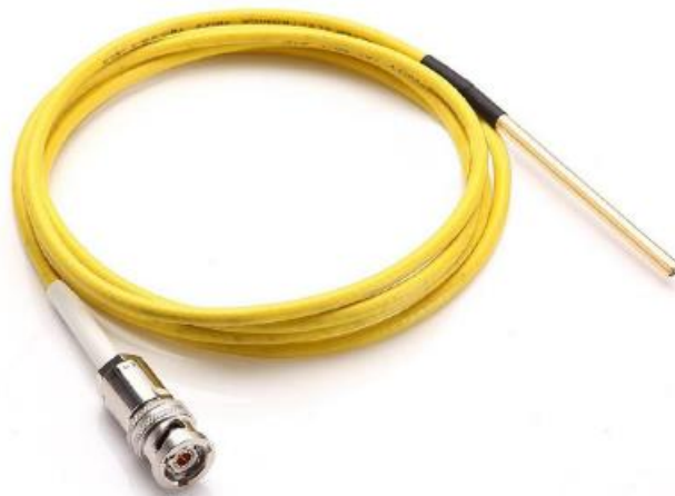
Figura 3.9: Tip holder de trabajo
