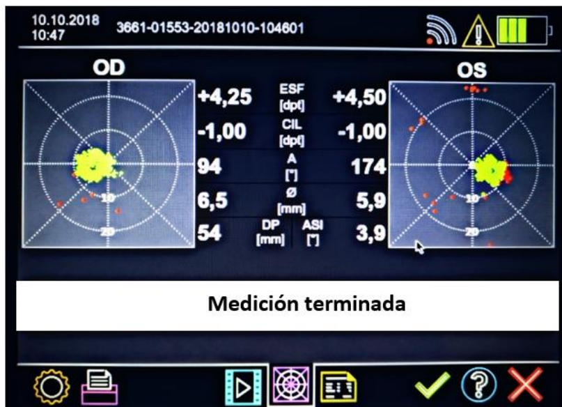
Figura 4. En la pantalla se muestran los diferentes parámetros: esfera, cilindro, eje, diámetro pupilar, distancia interpupilar y asimetría de mirada (medida realizada por la superposición del análisis de los puntos verdes de ambos ojos).
