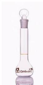
Matraz aforado de 10 mL clase A con tapón de plástico. Tolerancia  $\pm 0,025$ . Fabricado en vidrio borosilicato 3.3 de calidad superior. Usado para la preparación de todas las disoluciones
