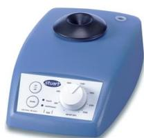
Agitador de laboratorio mecánico / vórtex. Se usó para la agitación de las soluciones preparadas con el objeto de garantizar disolución homogénea de los analitos.
