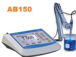
pHmetro AB150 marca Fisher Scientific: Calibrado con 3 soluciones buffer: 7,01, 3,00 y 10,01 Precisión  $\pm 0.02$  pH. Se usó para el monitoreo de pH en los experimentos
