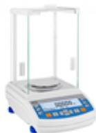
Balanza analítica para laboratorio. Precisión  $\pm 0,1$ mg. Se usó para pesar la cantidad de Oxitetraciclina necesaria en la preparación de la solución patrón. También se usó para pesar la cantidad de TiO<sub>2</sub> necesaria en cada experimentación.
