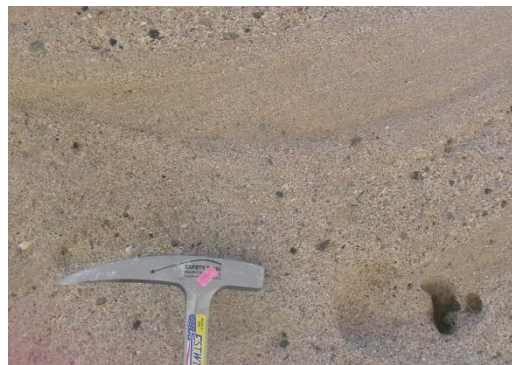
Figura 7. Piqueta de acero para toma de muestras de roca.
