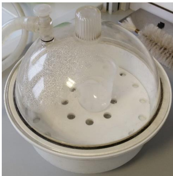
Figura 4.2.1: Bomba de vacío utilizada para el mojado de las membranas.
