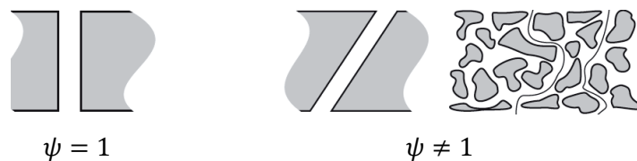
Figura 2.1.1: Tortuosidad para distintas configuraciones de poro dentro de una membrana.
