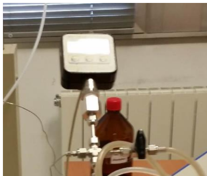
Figura 3.1.4: Transductor de presión instalado en el equipo.
