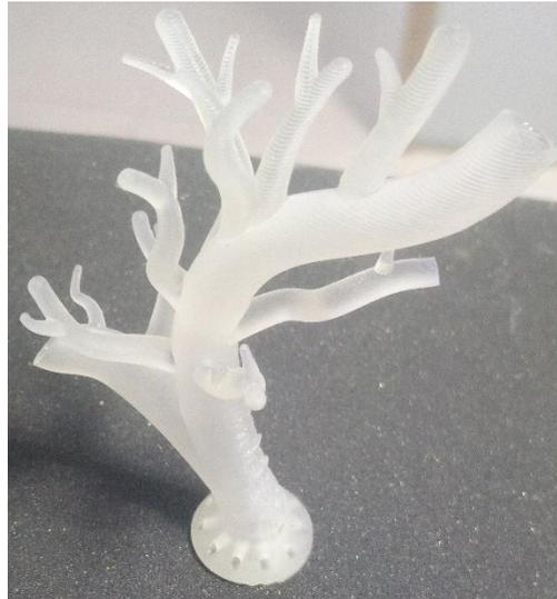
Figura 20: Arteria fabricada con la resina Elastic suministrada por Formlabs.
