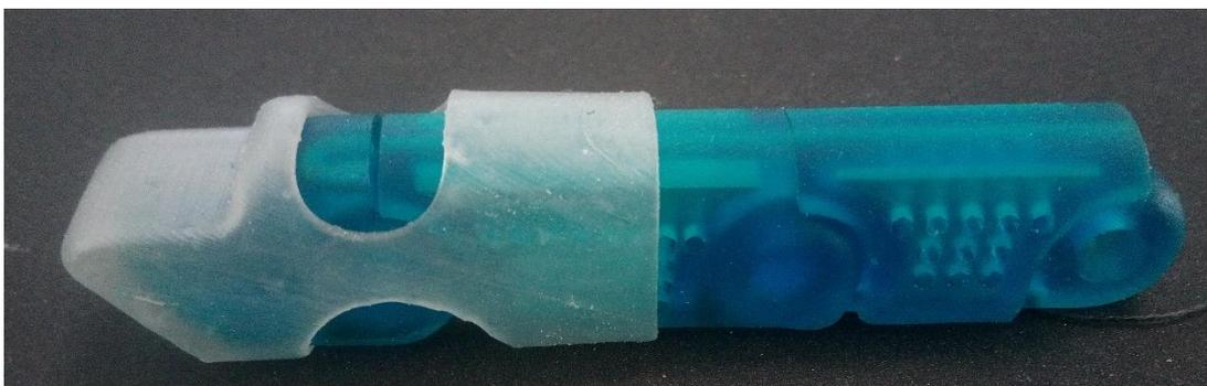
Figura 42: Posición inicial de la funda de la falange distal impresa con resina Elastic. (Elaboración propia).
