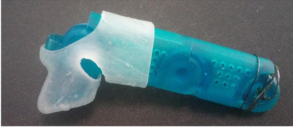
*Figura 43: Posición final de la funda de la falange distal impresa con resina Elastic. (Elaboración propia)*
