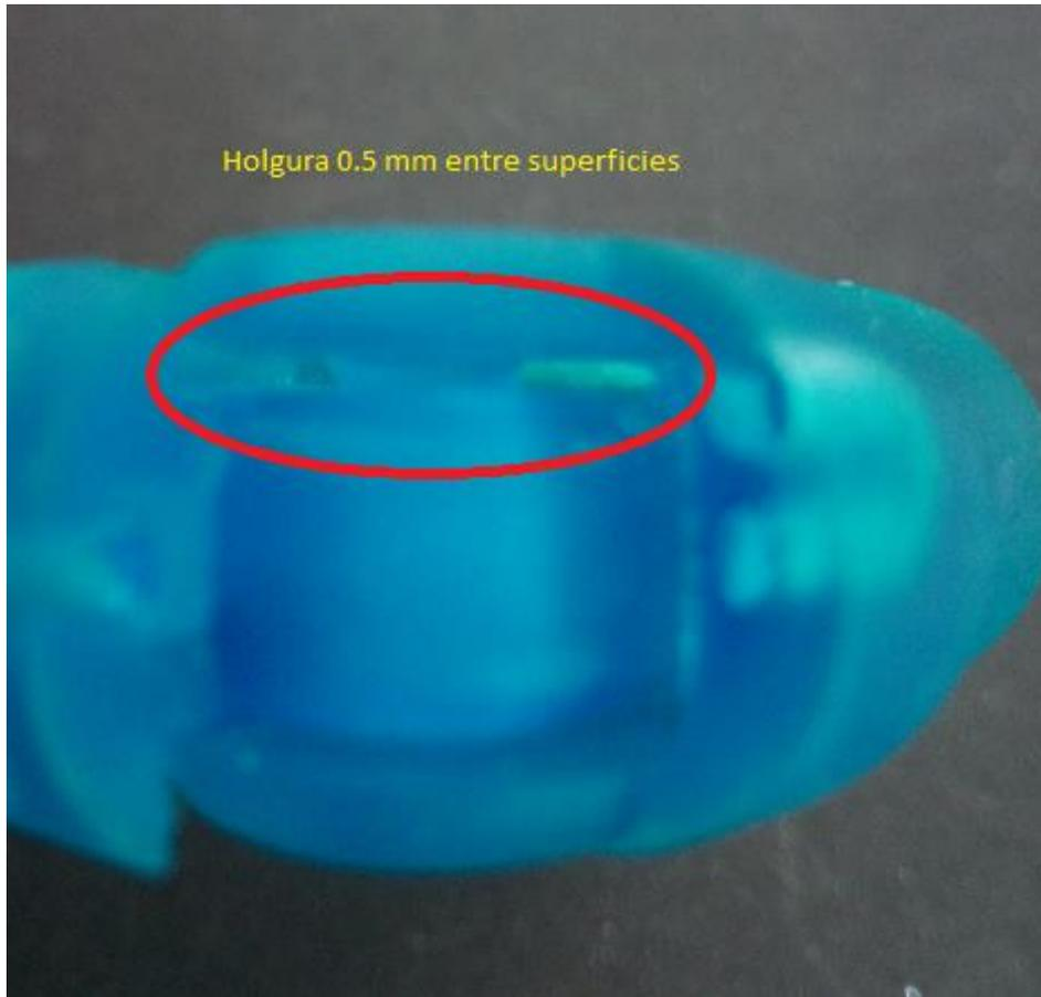
*Figura 34: Detalle impreso con resina Tough de la holgura existente entre falanges. (Elaboración propia)*
