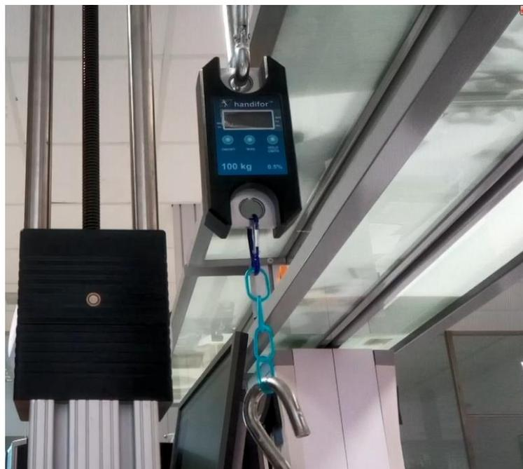
*Figura 19: Cadena realizada con la resina Tough a la que ha sido sometida a un ensayo para conocer el peso máximo soportado (Elaboración propia).*
