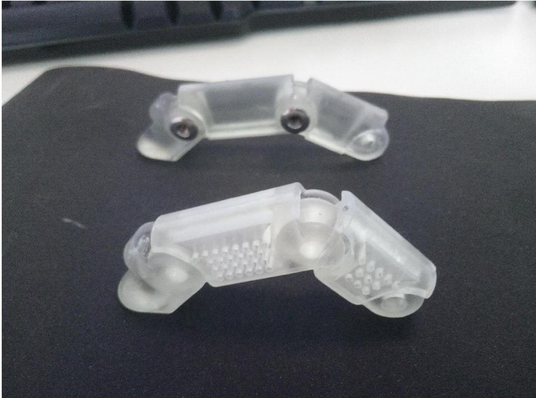
*Figura 36: Diseño 1 (detrás) y diseño 3 (delante) impreso con resina Clear. (Elaboración propia)*
