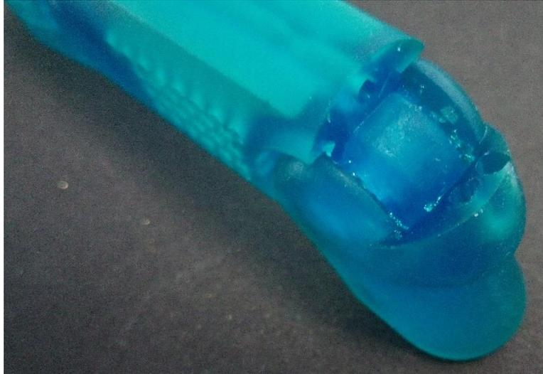
*Figura 35: Detalle impreso con resina Tough con la holgura mínima de 0.25 mm. (Elaboración propia).*
