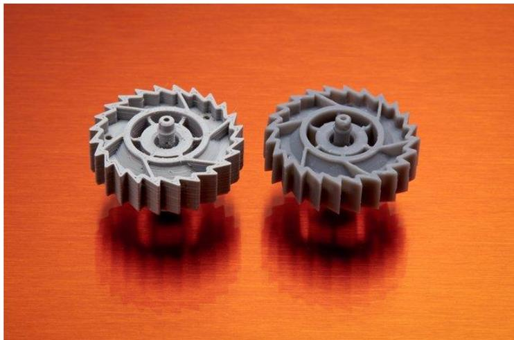
Figura 9: Comparación calidad superficial FDM (izquierda) y SLA (derecha).
