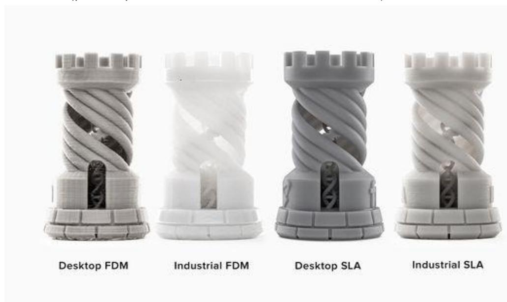
*Figura 15: Comparación calidad superficial y precisión de impresión 3D FDM y SLA. ([http://www.jvasconcellos.com.br/fat/FAT\\_TI/wp-content/uploads/2017/08/SLA\\_Guide.pdf](http://www.jvasconcellos.com.br/fat/FAT_TI/wp-content/uploads/2017/08/SLA_Guide.pdf))*
