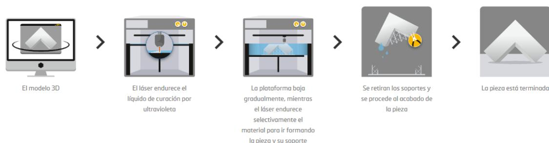
*Figura 4: Proceso de impresión de una impresora 3D por estereolitografía*
