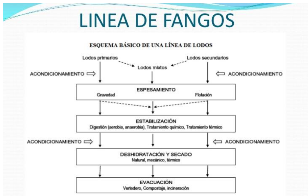
Figura 3. Esquema línea de fangos
