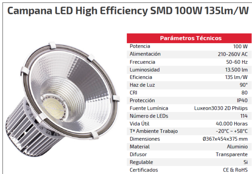
Ilustración 1: Características de la luminaria elegida para la iluminación de la nave
