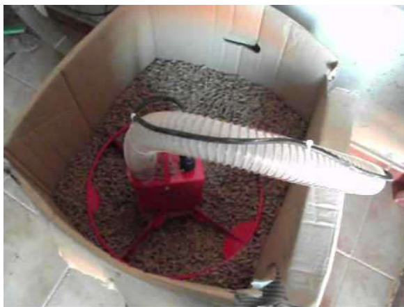
Figura E.7: Sistema de alimentación neumático. Fuente: Sinersol.
