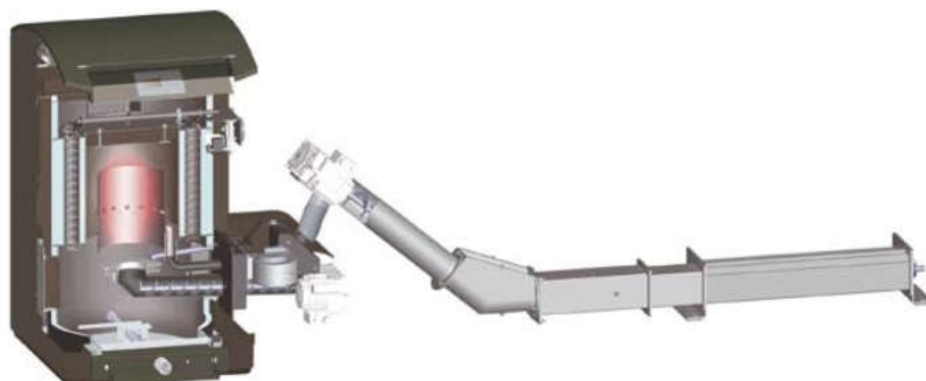
Figura E.6 Caldera abastecida mediante tornillo sinfín. Fuente: Heizomat.
