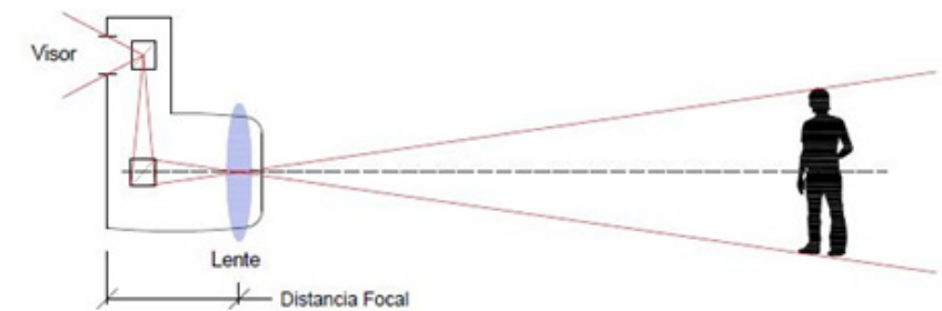
Esquema propio del funcionamiento de una cámara Réflex.
