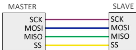
Figura 5.3: Comunicación SPI
