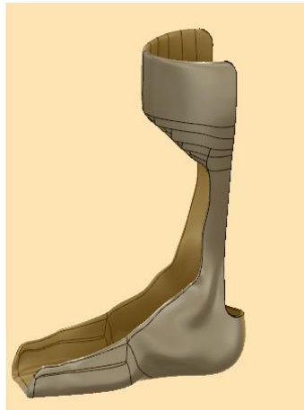
Ilustración 84-Resultado de la eliminación de la parte trasera de la órtesis. Elaboración propia.
