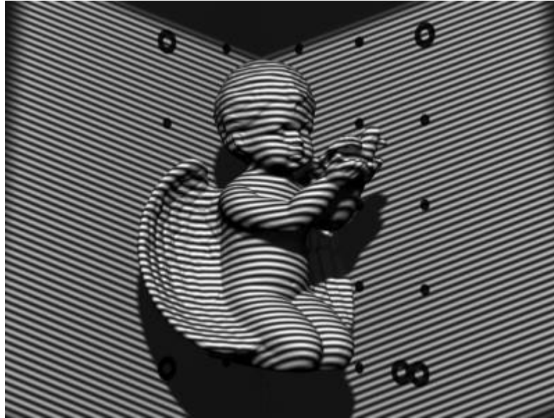
Ilustración 14- Ejemplo proyección patrón luz estructurada.
