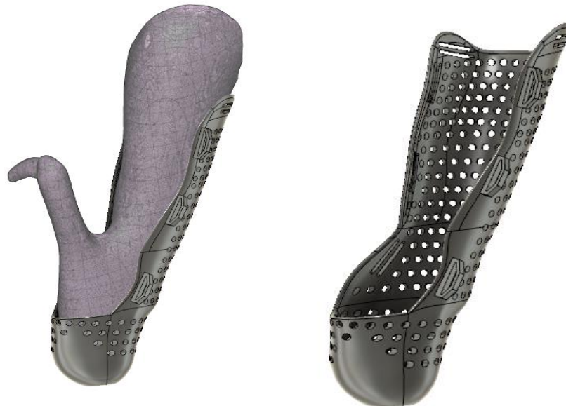
Ilustración 23-Extremidad escaneada con escáner de luz estructurada y prótesis creada a partir del escaneado.
