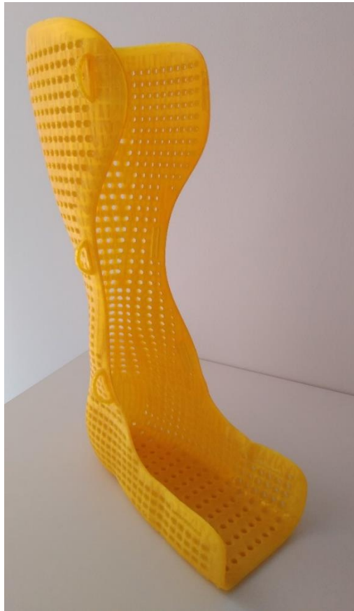
Ilustración 114- Órtesis para pie y tobillo fabricada en P.E.T.G.
