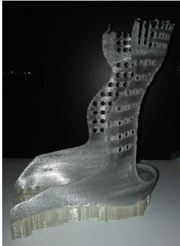
Ilustración 79-Fallo en la impresión de prototipo con espesor de 2mm. Elaboración propia.
