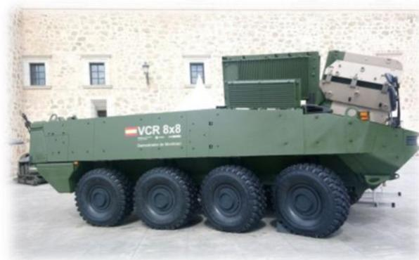
**Figura 4.7:** Vehículo de combate sobre ruedas (VCR) 8x8 Dragón.
