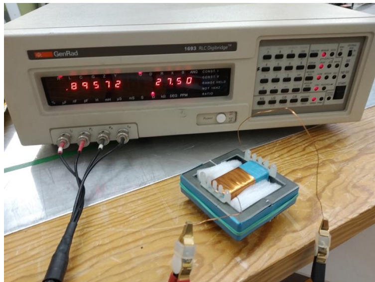
Ilustración 57. Resistencia y factor de calidad de la inductancia construida.
