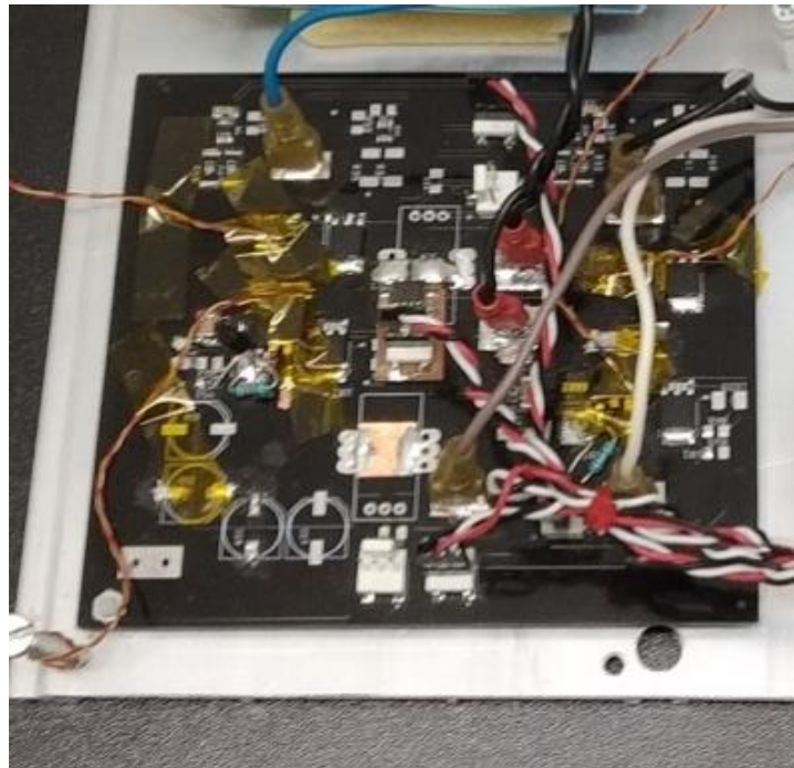
Ilustración 71. Detalle colocación termopares.
