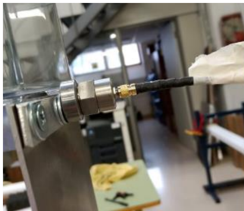
Figura 3.5: Acelerómetro unido a la maqueta
