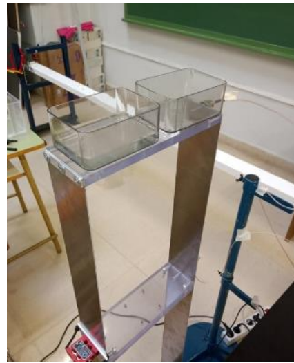
Figura 4.18: Otra vista del depósito sintonizado
