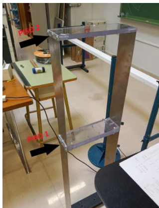
Figura 3.8: Maqueta del edificio
