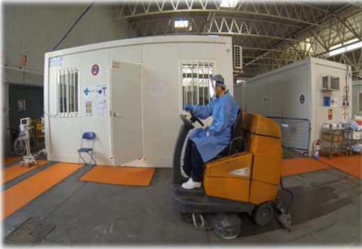
Hidrobarredora Suelos con Hipoclorito Sódico al 0,1%
