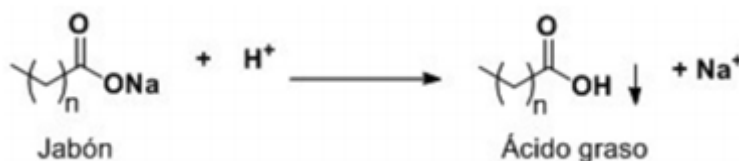
Fig. 9 Reacción de un jabón en aguas ácidas
