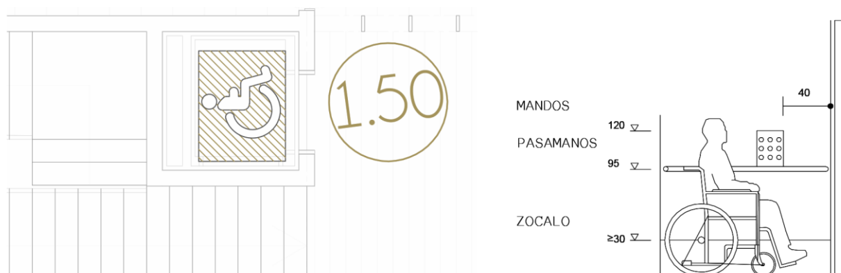
23 - Planta y sección dimensiones ascensores
