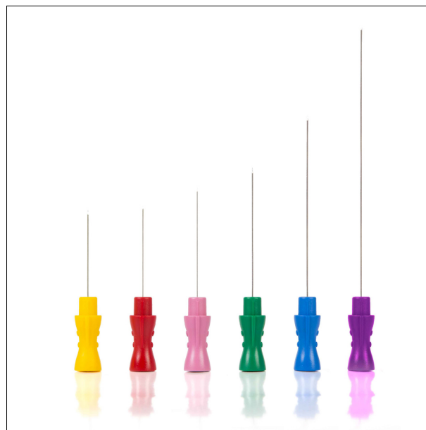
Figura 2.13 : electrodo EMG invasivo de aguja, extraído de CNSac [32]
