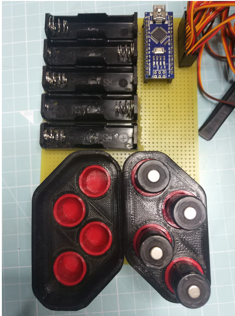
Figura 3.29 : circuito de alimentación y control de los servomotores de la mano
