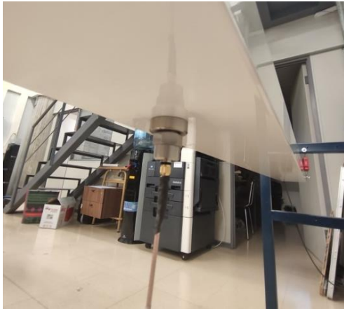
Imagen 17. Detalle colocación acelerómetros
