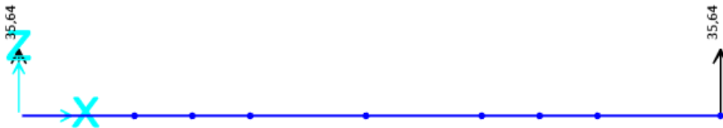
Imagen 63. Reacciones apoyos 2º análisis debido al peso propio de la pasarela
