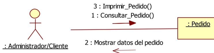
Figura 13: diagrama de colaboración imprimir pedido
