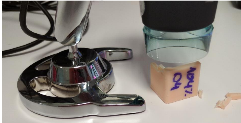
Figura 9.3 Foto del microscopio observando una probeta.
