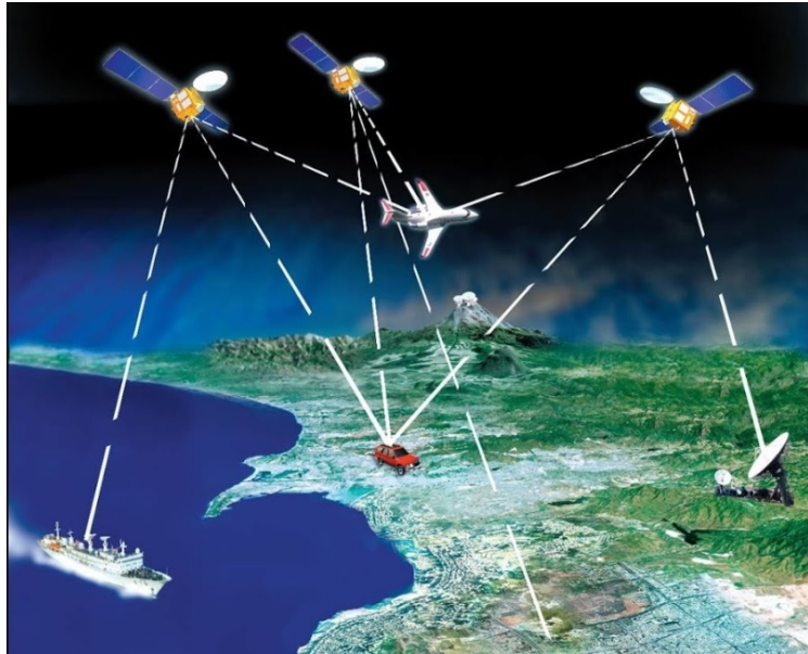
Figura 75 El componente de usuario del GPS mide las distancias a tres satélites y, en tiempo real, determina la posición geográfica.
