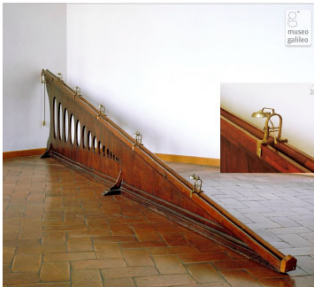
Figura 9 Dispositivo experimental de Galileo para el estudio del movimiento acelerado (Museo Galileo de Florencia).
