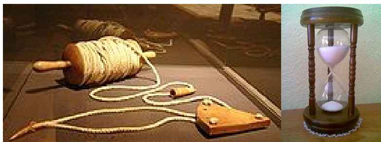
Figura 52 Equipo de medida de la velocidad de un navío por el procedimiento de la corredera de barquilla . La cuerda poseía nudos a distancias regulares para determinar rápidamente su longitud.
