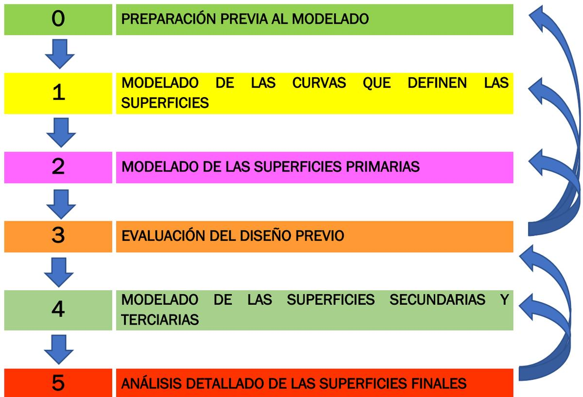
Figura 29. Esquema del proceso de modelado
