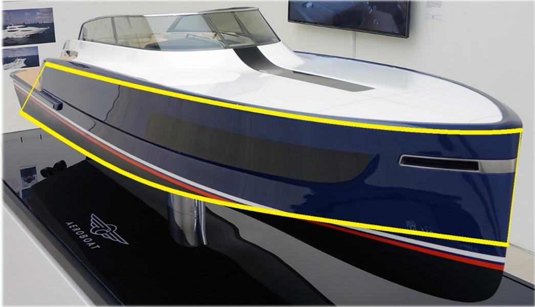
*Figura 108 Superficie principal del casco. [1]*
