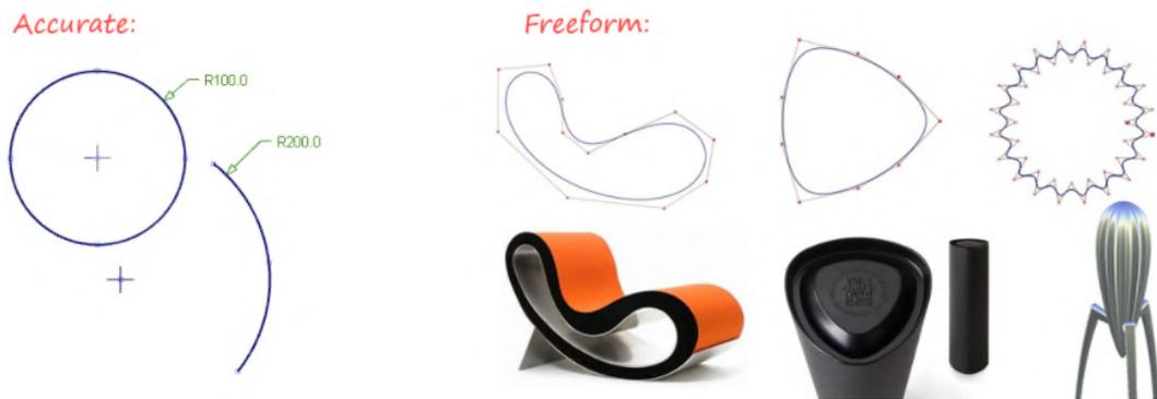
Figura 14. Ejemplos de curvas circulares precisas y de forma libre [1]
