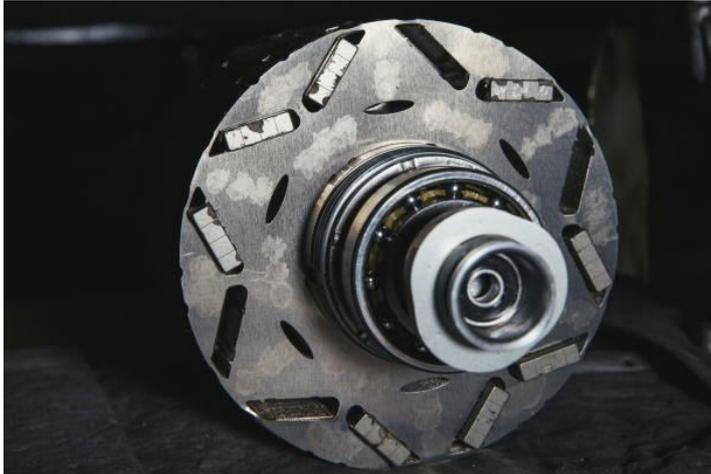
Figura 57-Estator del motor de reluctancia con imanes permanentes
