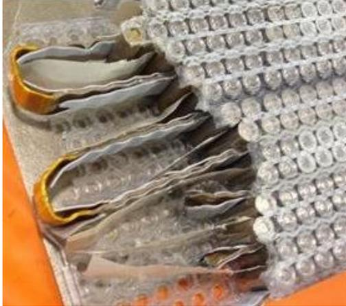
Figura 25-Sistema de refrigeración de las celdas
