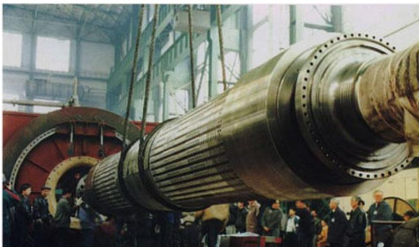
Figura 27- Generador de rotor cilíndrico
