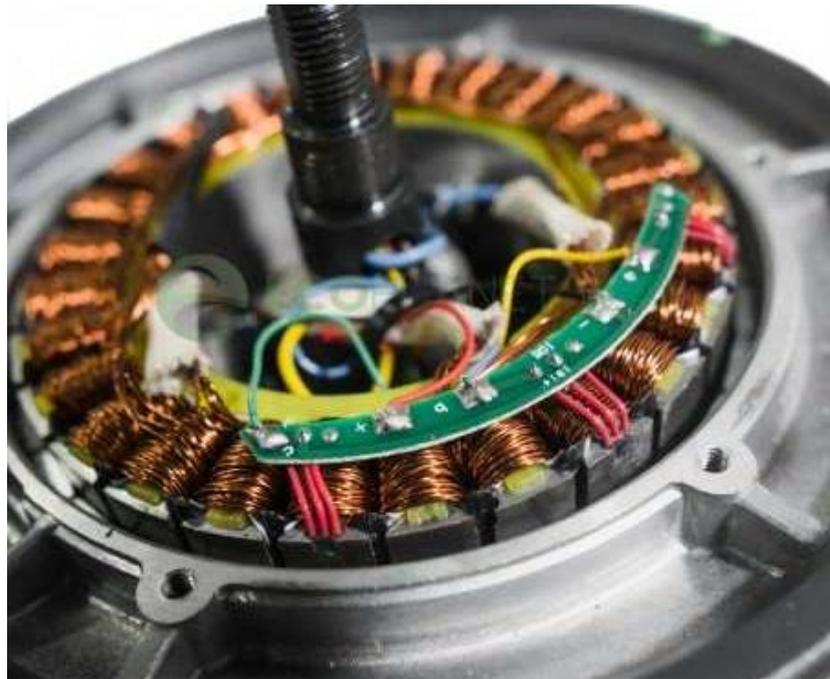
Figura 67- Sensores Hall en el estator del motor
