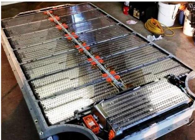
Figura 23- Paquete de batería de tesla Model S
