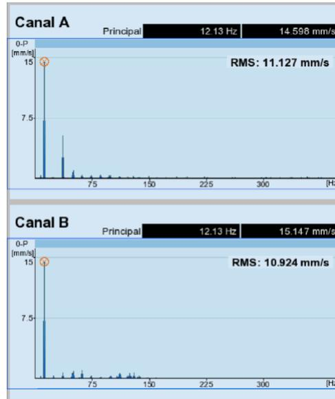
Ilustración 98. Espectro de frecuencia de primer punto de resonancia [Elaboración propia]
