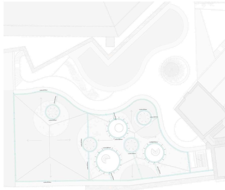
04 PLANTA CUARTA CUBIERTA EVACUACIÓN DE AGUAS PLUVIALES
