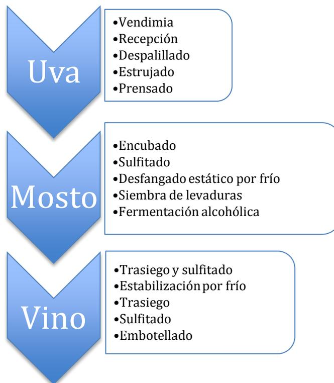
Fig 1. Diagrama de flujo del proceso de vinificación realizado
