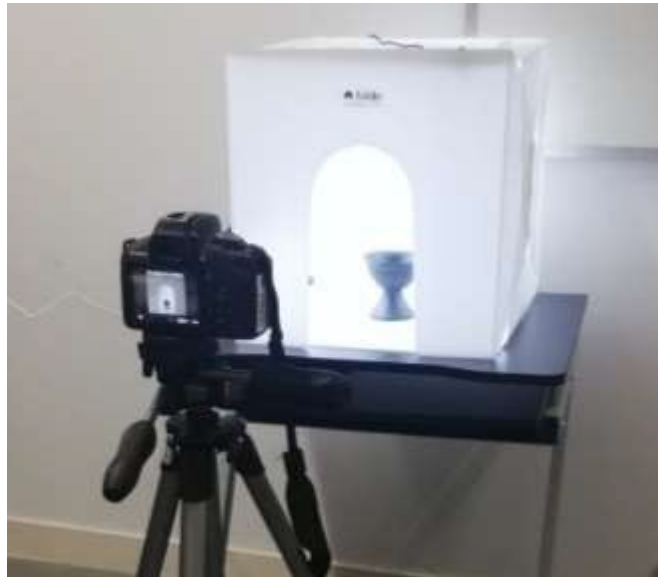
Figura 5. Caja de Luz portátil y montaje completo para la adquisición de imágenes para el desarrollo de modelos fotogramétricos.
