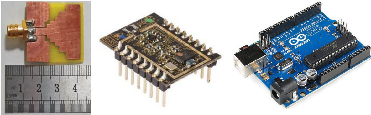
Figura 5. (a) Antena plana sobre circuito impreso (b) Módulo Lambda62 con módem LoRa de Semtech (c) Arduino Uno para comunicarse digitalmente con el módulo de radiocomunicaciones LoRa.
