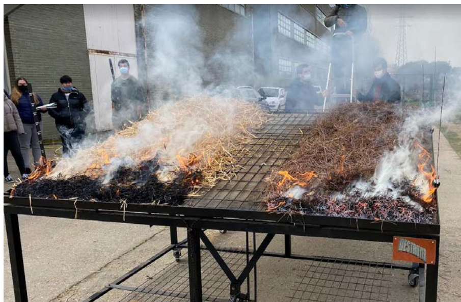
Figura 1B. Desarrollo de la quema en la que los estudiantes de unos de los grupos comparaban la propagación del comportamiento del fuego bajo diferentes combustibles (Modelo 1 y Modelo 9) y pendientes con orientaciones opuestas.
