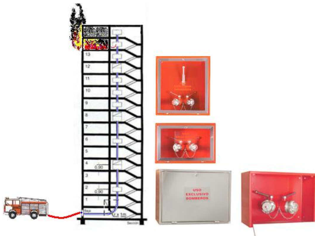
Figura 38.- Sistema de columna seca
