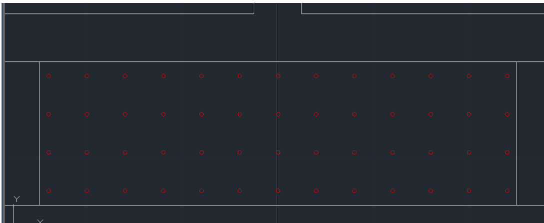
Figura 67.- Detalle distribución rociadores RO3
