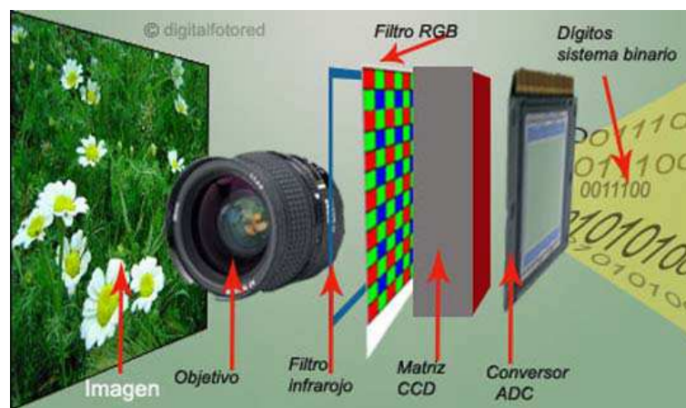
Figura 3.4 – Esquema de una cámara digital.
