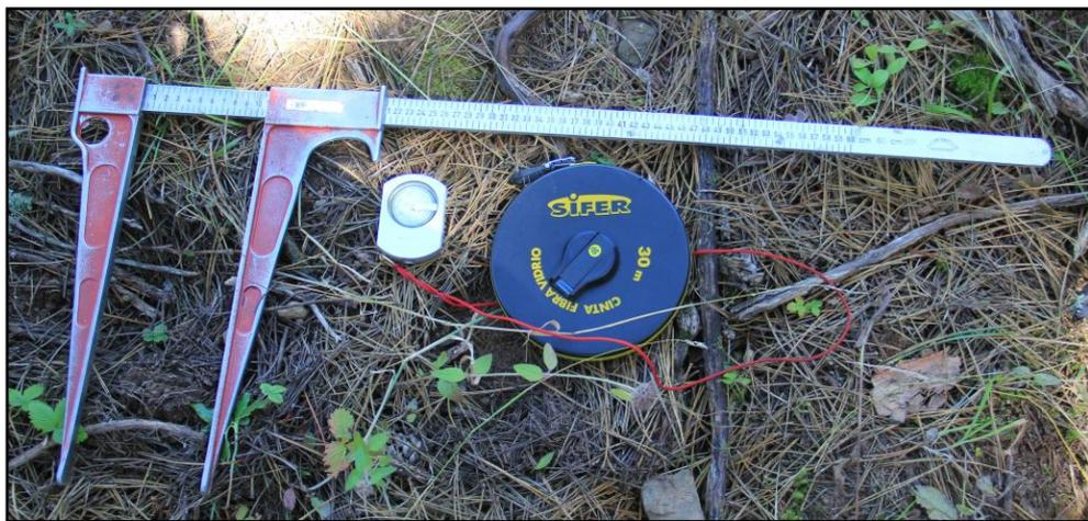
Imagen 15: Material empleado en el proceso de inventario. De izquierda a derecha: Forcípula, hipsómetro y cinta métrica. Fotografía propia (14/09/2013)
