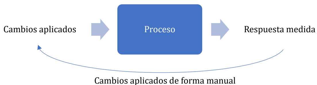
Figura 3. Diagrama explicativo del Lazo Abierto de Control.
