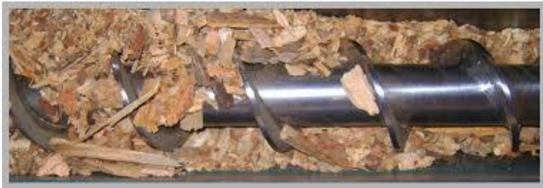
Figura 17: tornillo sinfín transportando biomasa. Fuente: avión.es
