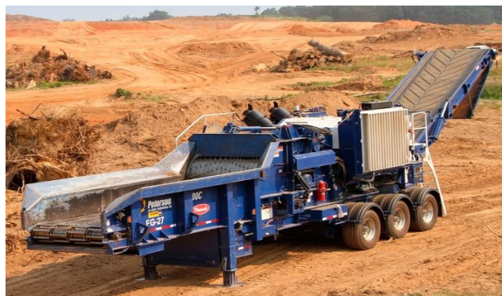
Figura 2: astilladora de tambor. Fuente: TCPEL.com
