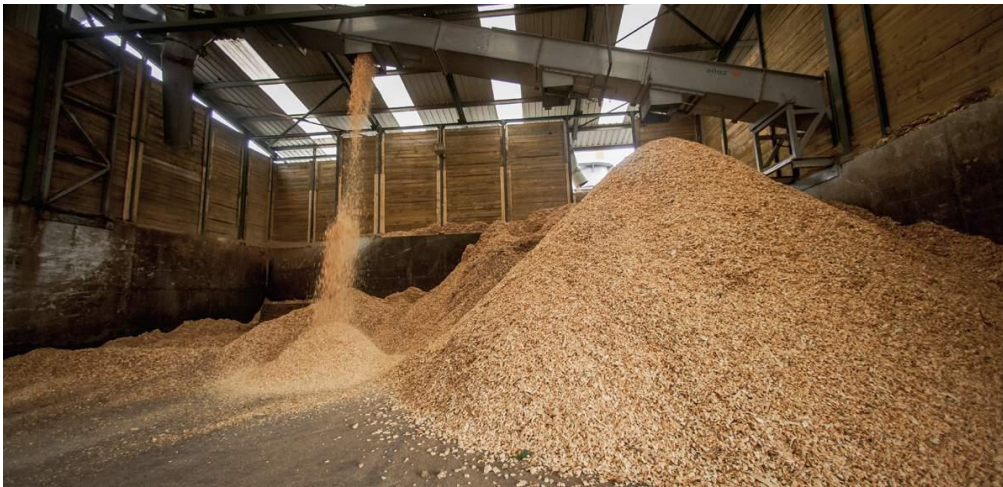
Figura 9: caída de la biomasa desde el secadero Fuente: AVEBIOM.org
