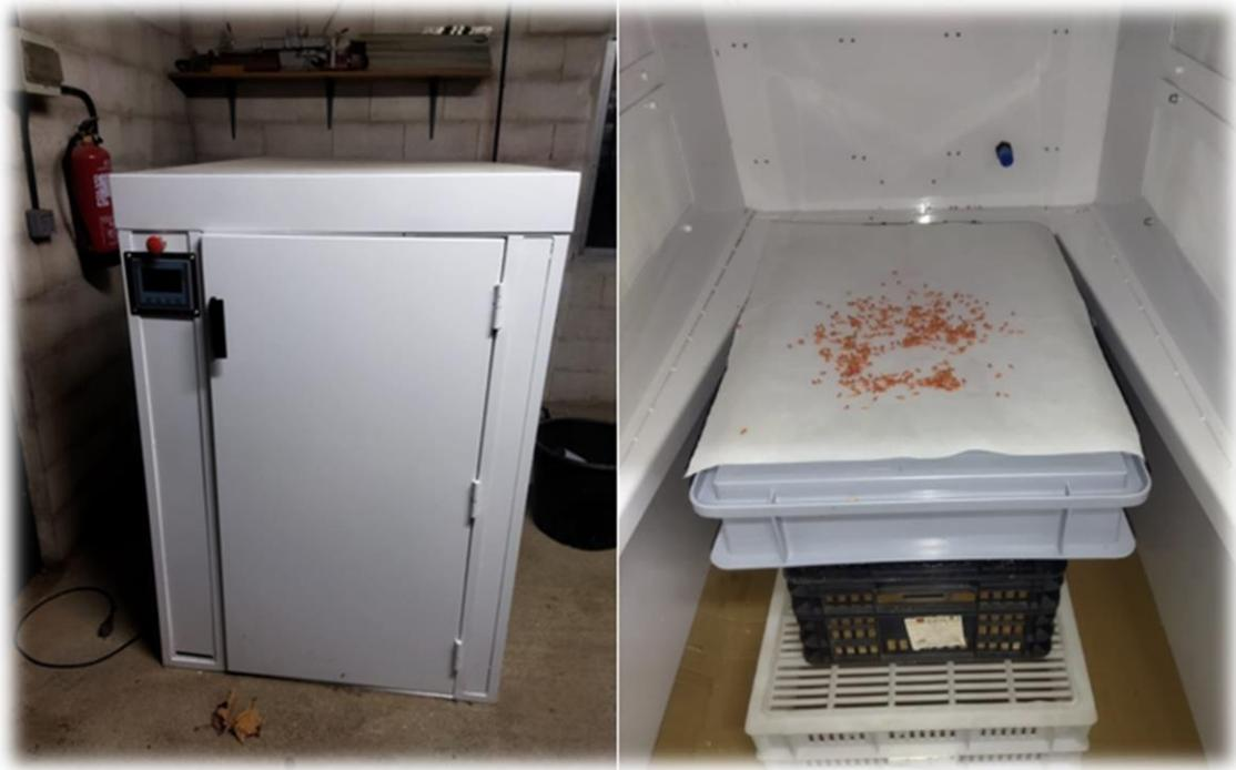
**Figura 4.1** equipo tratamiento UV y ozono, parte exterior (izquierda) y parte interior (derecha).
