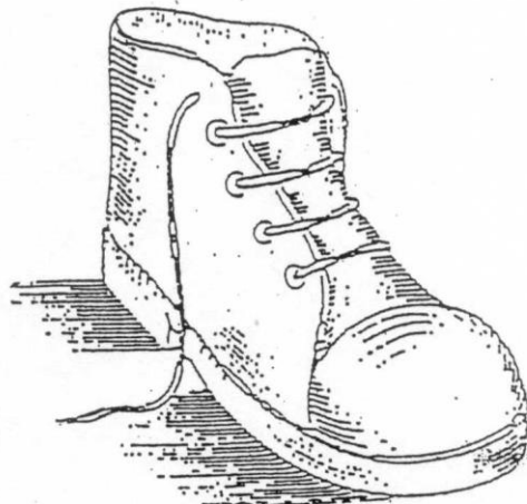
PUNTERA DE ACERO DE 1,5 MM. DE ESPESOR PLANTILLA DE ACERO DE 0,50 MM. DE ESPESOR. PUNTERA DE GOMA EXTERIOR.
