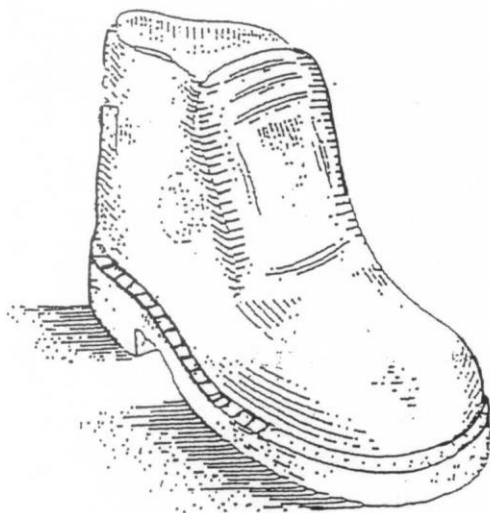
PUNTERA DE ACERO DE 1,5 MM. DE ESPESOR. PISO DE NEOPRENO VULCANIZADO ANTIDESLIZANTE.
