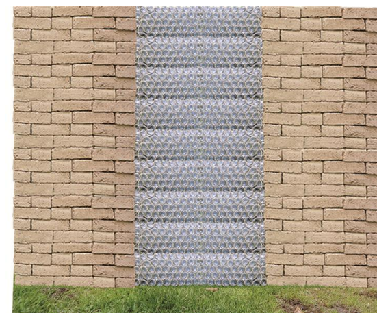
(75). Muro mixto de fábrica de adobe y PET
