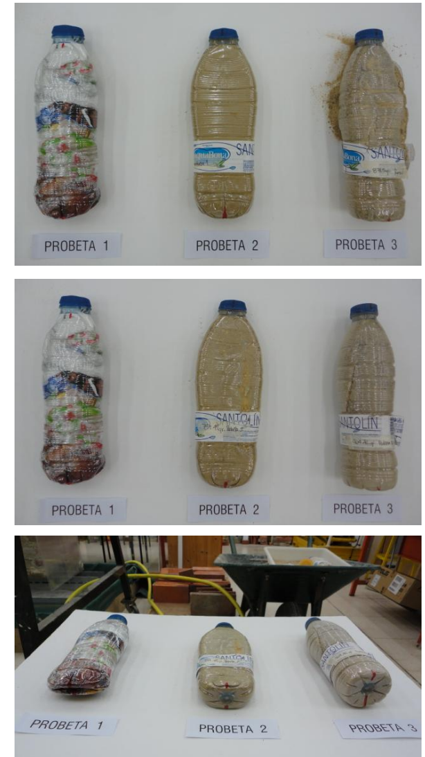
(67).Comparación de las 3 probetas de arena después de la aplicación de la fuerza
