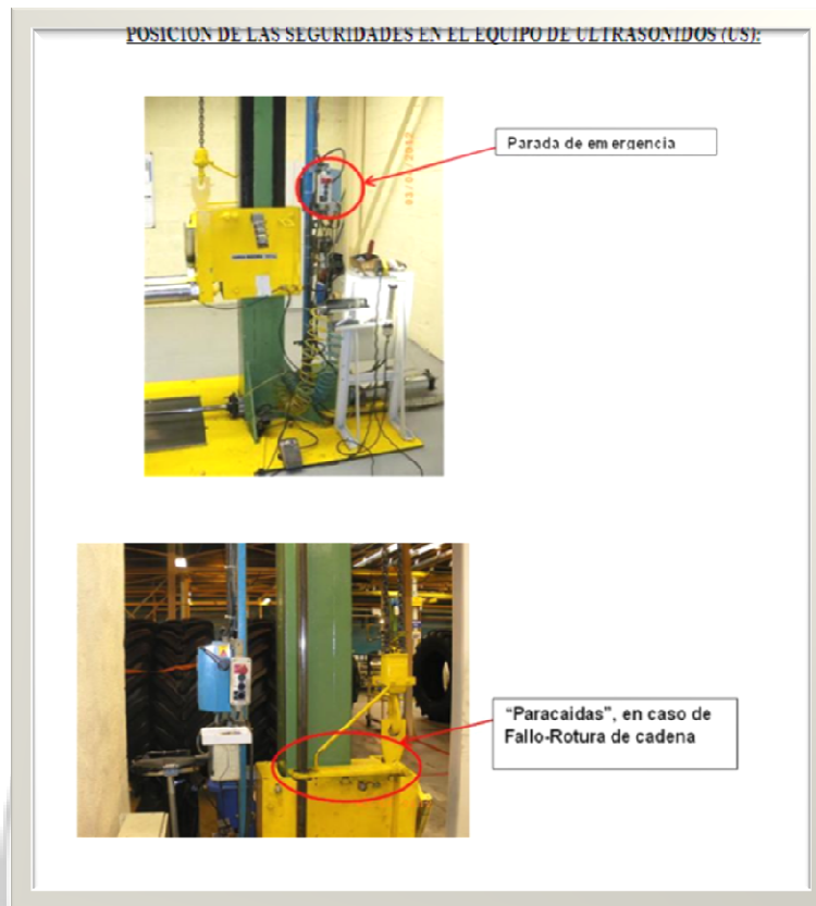
Imagen 11: Ejemplo de localización de medidas de seguridad.
