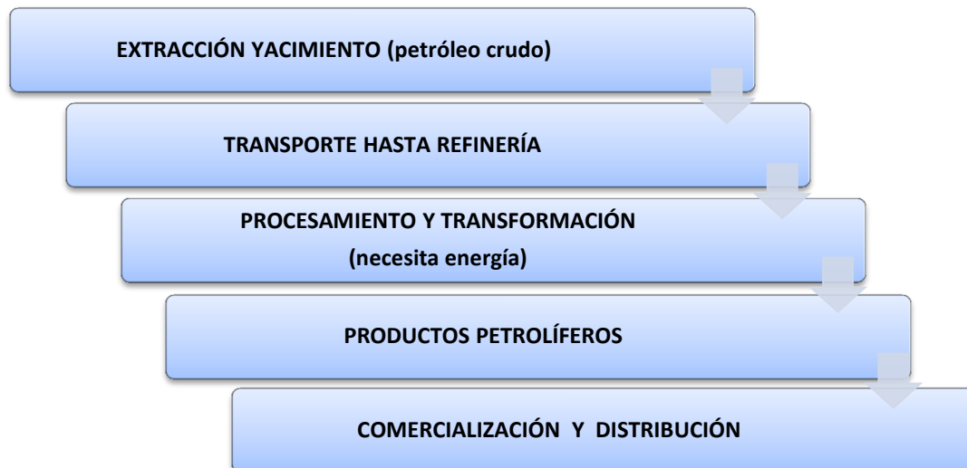
Gráfico 2.1 Proceso de obtención de productos derivados del petróleo.
