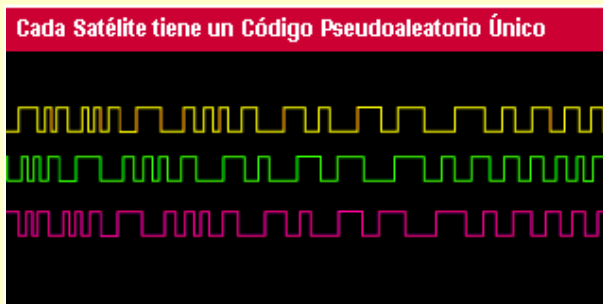
Fig. 9 El código de identificación de un satélite GPS es una larga y compleja serie binaria, única para cada satélite y diferente de todos los demás.
