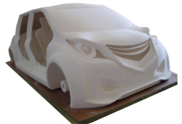
base (imprimación). Suele ser de color aparejo, el cual es necesario volver a lijar para posteriormente aplicarle la pintura final deseada. La pintura aplicada corresponde con la misma que la pintura de carrocería de vehículo para poder simular el acabado de un vehículo real.
