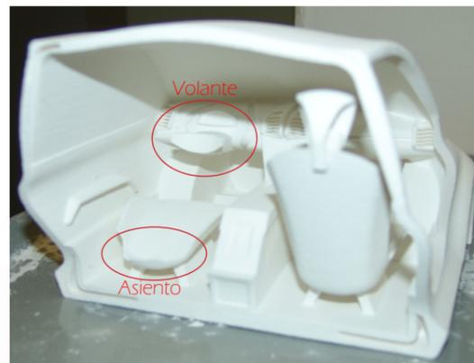
posición de estas partes. Entre ellas se encuentra el asiento del conductor debido a su espesor de 1,5mm, al volante por su frágil unión, al retrovisor, al detalle de la parte delantera...
